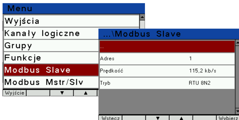
Rys.22. Konfiguracja parametrów protokołu Modbus w trybie Slave
